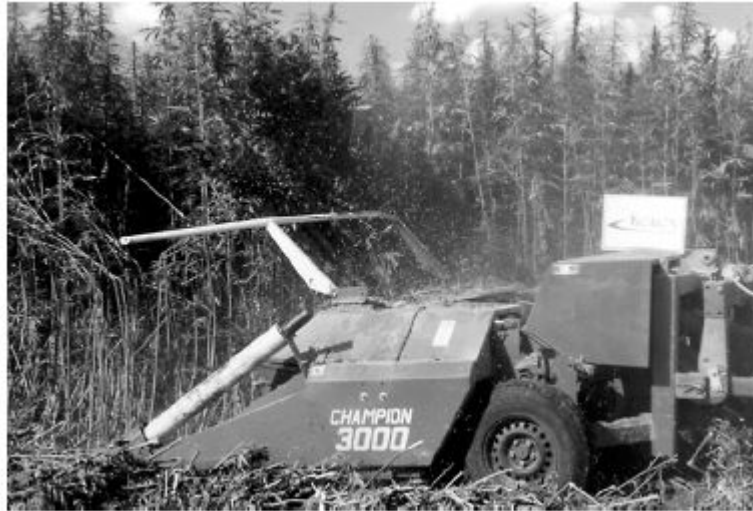
Rys 10. Champion 3000 kombajn używany w Ameryce z obrotowymi nożami.
