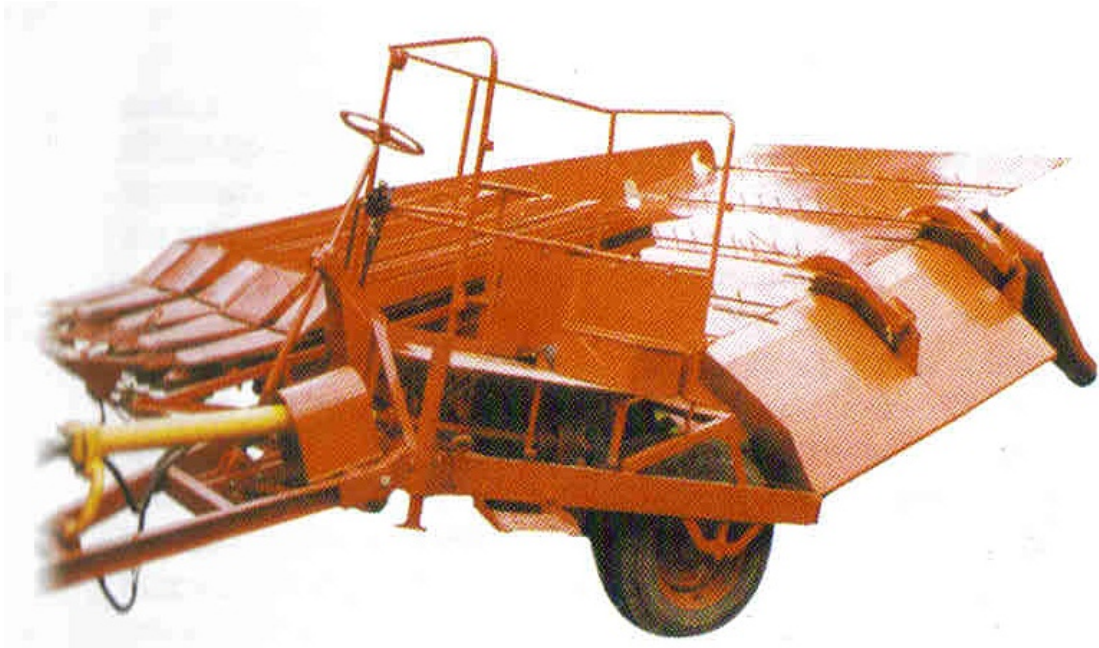
Rys 8. Kosiarka ciągnikowa do zbioru konopi
